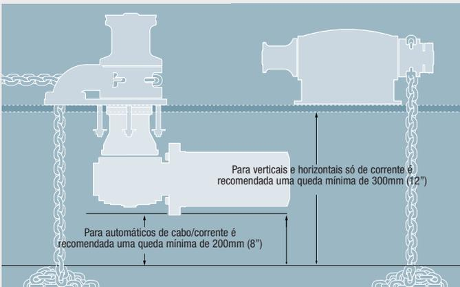
As distâncias mínimas de queda recomendadas medem-se desde cima da estaca do cabo / corrente (corrente ou cabo/corrente) após recuperação total da âncora.
